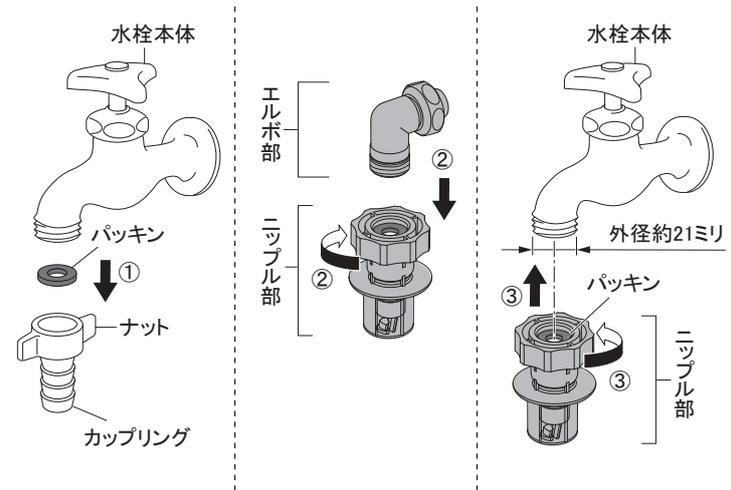
\*作業後は、再度各取付部をしっかりと締付けてください。
