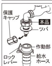
①本品に付いている保護キャップを外し、給水ホースの作動部を引きながら、カチッとき音がするまで本品にしっかりと差込みます。
