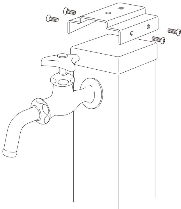
②取付部と本体のビス穴を合わせ、ビス(短)2本で締付け固定します。
