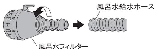
④洗濯機の風呂水給水口のキャップを外し、本品の接手が風呂水給水口のパイプのツバ部に確実に掛かるよう、差込みます。
