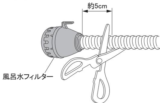
②風呂水フィルターに残っているホースの先端に切れ目を入れ、ホースを矢印の方向にまわしてちぎりがちぎらながら取除きます。
