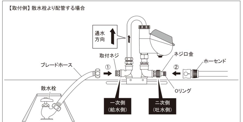
①ブレードホース(別売)などで、給水栓と本品の一次側(給水側)の取付ネジを接続します。
