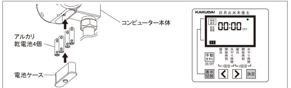
①コンピューター本体底部にある電池ケースを外し、電池ケースにアルカリ乾電池4個を入れます。
