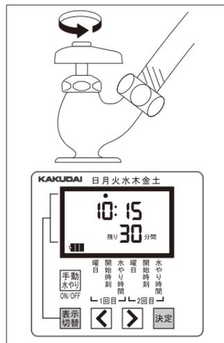
①給水栓のハンドルを開きます。**表示切替** ボタンを押して**時刻表示** を選択し、**手動水やり** ボタンを押して水を出します。水が出たら接続部分に水もれがないか確認し、水栓のハンドルで流量を調節します。(表示パネルは左図のようになります)
